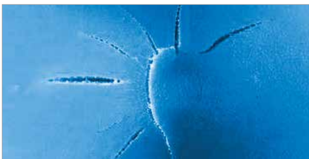
Poškození dlouhodobým působením napětí
