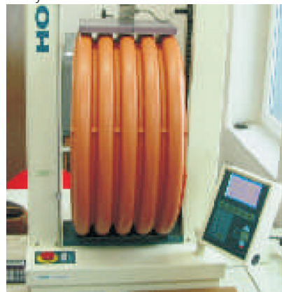
Obr.6: Stanovení kruhové tuhosti potrubí InCor®
