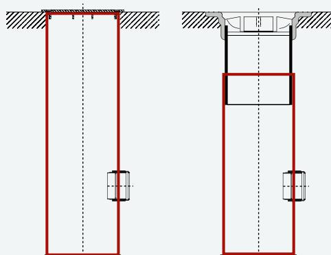
Musí-li se kanalizační potrubí nainstalovat nad šachтовé dno, může se použít tzv. spadiště. Spojuje se pomocí in situ těsnění do DN 200. K propojení se používají odbočky a redukce.
