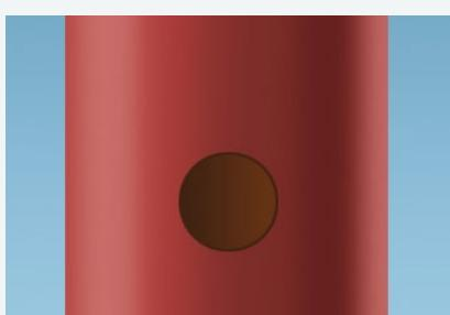
Do šachtové trouby předvrtáme otvor ve středu napojení potrubí a očistíme od nečistot.
