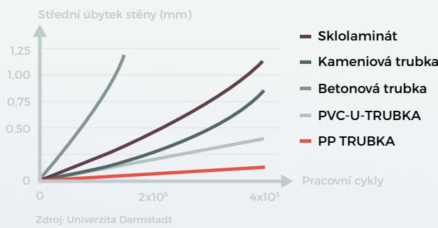
Polypropylen exceluje i v provozních vlastnostech. Kromě odolnosti vůči nárazům, plošným dynamickým rázům a mrazu je také odolný vůči:
